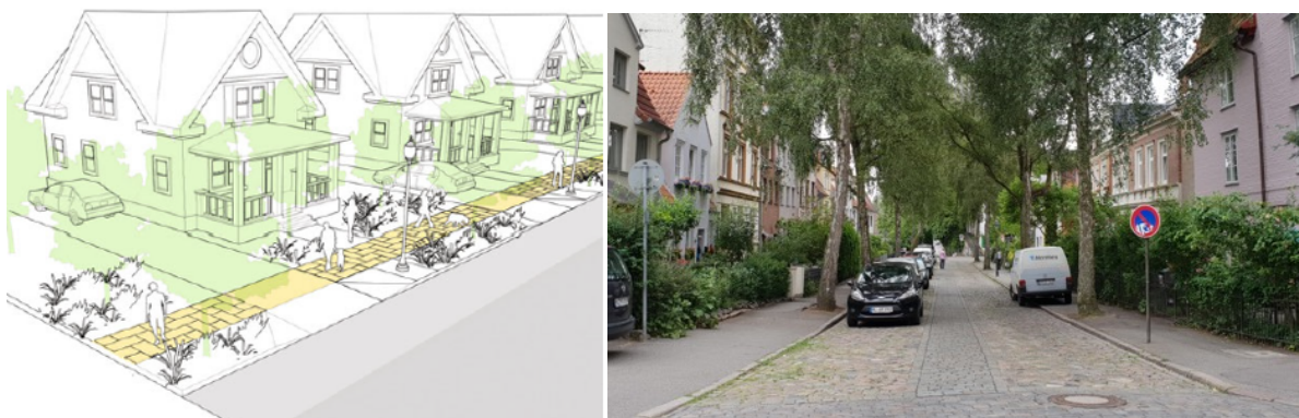
Joonis 2. Aedlinna kõnnitee. Fotel kuvatu pole ideaalne näide, kuna puud võtavad kõnniteel liikujalt ruumi ära.
